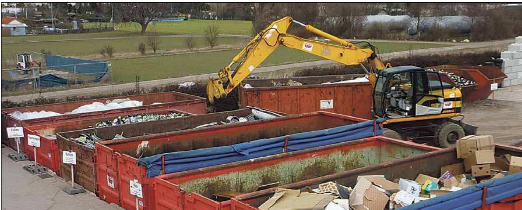
Schweres Gerät: Ein Bagger verdichtet die Abfälle in den Containern, damit möglichst viel hineinpasst und so Transportwege gespart werden können.
