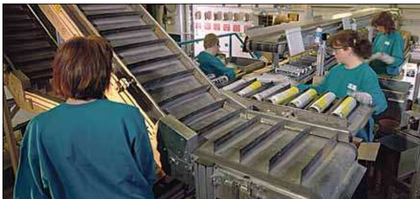
Erster Schritt des Recyclings gebrauchter PUR-Schaumdosen ist die manuelle Vorsortierung nach 1- und 2-Komponentenschäumen, die in separaten Anlagen verarbeitet werden. Die Betriebswerkerinnen entfernen gleichzeitig die Verschlusskappen, die anschließend zu Granulat gemahlen werden.
