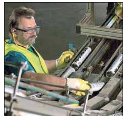
Über ein Förderband gelangen die 1-K-PUR-Schaumdosen in die Recyclinganlage, wo sie unter Luftabschluss geknackt und mechanisch zerkleinert werden.
