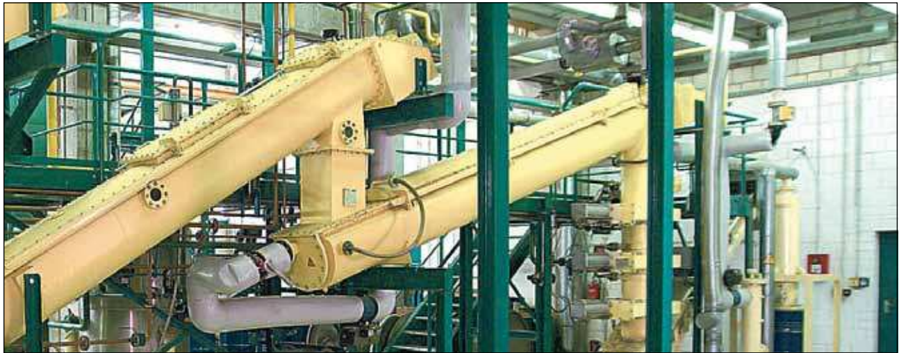
In der so genannten Waschschncke werden die Metallteile der zuvor mechanisch zerkleinerten 1-K-PUR-Schaumdosen gereinigt. Die Metallteile werden anschließend getrocknet und in Aluminium- und Weißblechcontainer sortiert.
