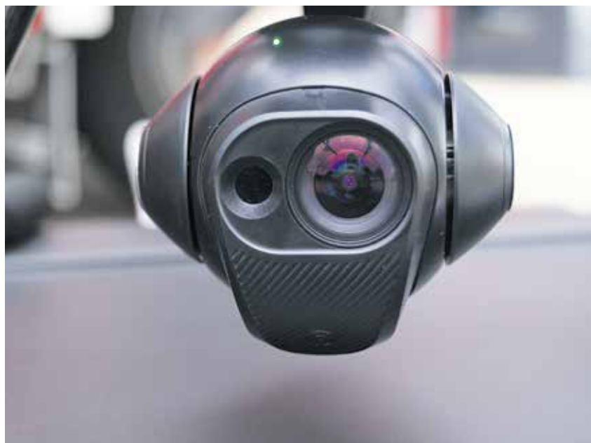
Durch die Ausstattung mit Wärmebild- und Restlichtkameras ermöglichen die Drohnen die Suche nach Brandherden und Glutnestern auch in der Nacht oder wenn die Baumkronen eine direkte Bodensicht verhindern. Fotos: KV/Fickus
