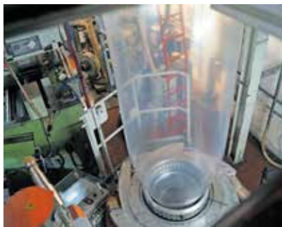
Herstellung: Die Folien werden ausgeblasen ...
