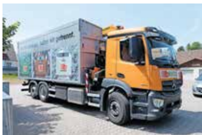
Getrennte Abfuhr: Fahrzeug mit zwei Kammern. Fotos (2): Firma Becker
