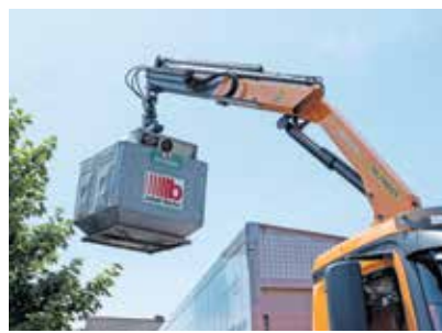
Abholen der Container: Das Fahrzeug arbeitet mit Kranhub.
