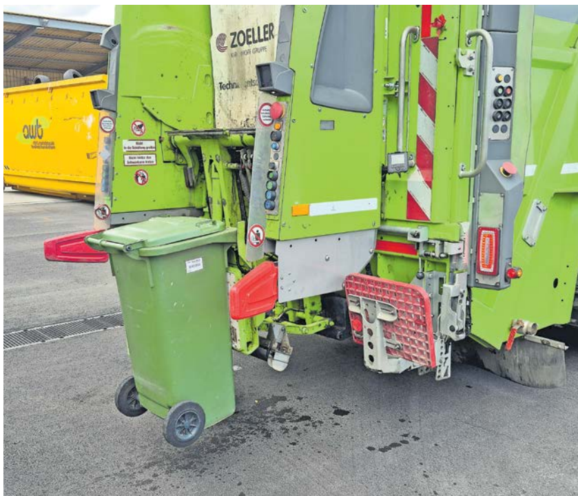
Nichts geht mehr: Stellt die Scan-Technik einen Fehlwurf fest, wird die Leerung der Biotonne gestoppt. Foto: KV/Estelmann
